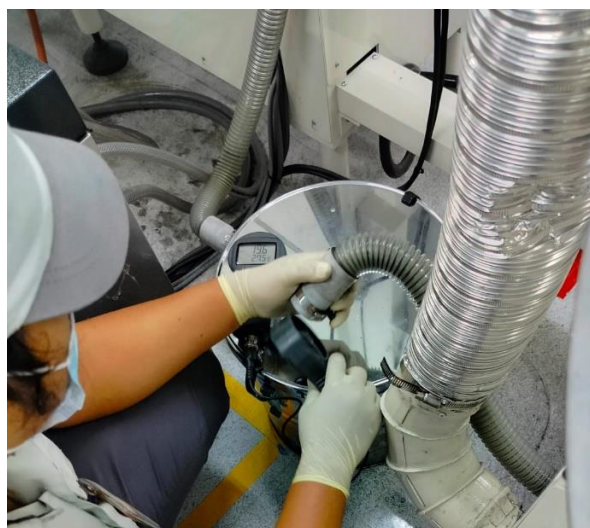
Gambar 3. Proses pengukuran kecepatan angin
