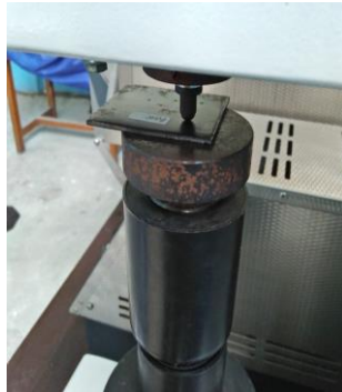
Gambar 1. Posisi spesimen pada anvil
