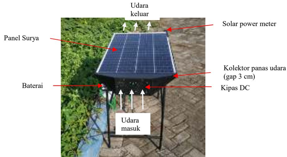
**Gambar 1.** Foto Eksperimen PV/T dengan kolektor pemanas udara
