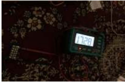
Gambar 1. Pengujian Kabel NYA Kondisi Normal dengan Insulation Tester
