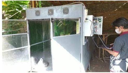
Gambar 2. Percobaan Alat pengering kain batik
