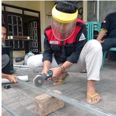
Gambar 1. Proses pemotongan besi pada untuk kerangka pengering
