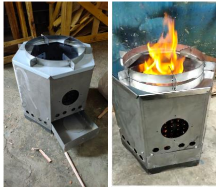
Gambar 4 Perakitan dan pengujian kompor rudal
