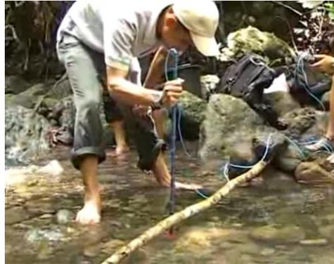
Gambar 4. Pengukuran debit aliran air pada lebar penampang 1,5 meter
