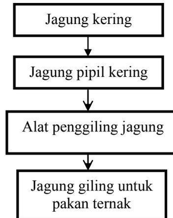
Gambar 1. Diagram Alir Pembuatan Pakan Ternak dari Jagung Pipil Menggunakan Mesin Penggiling Jagung (*disk mill*)
