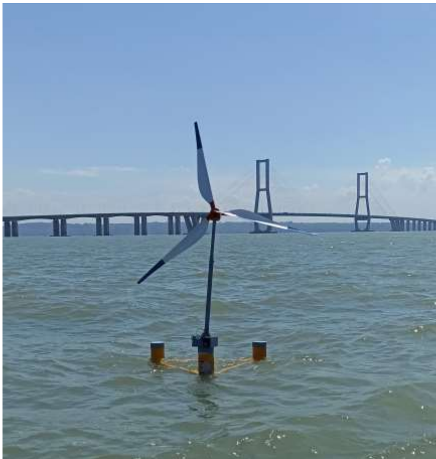
Gambar 6. Uji kestabilan dan pengambilan data kecepatan angin dan luaran tegangan pada sudut masuk \alpha = 0^\circ
