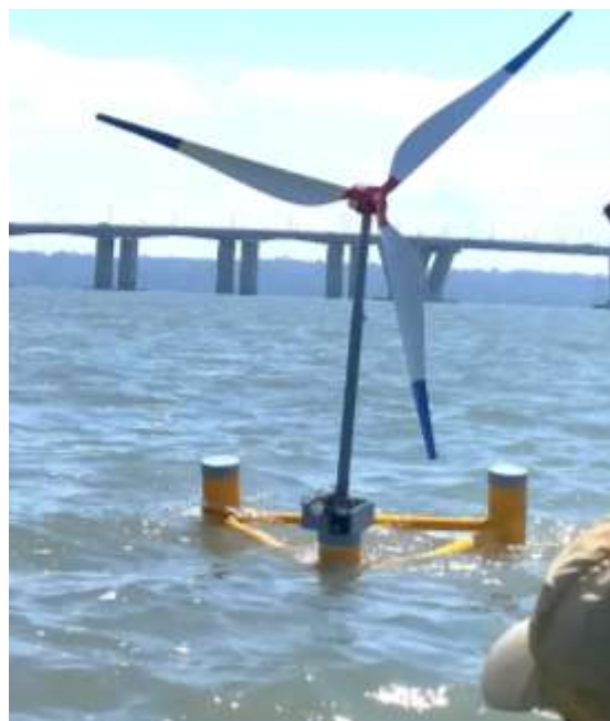
Gambar 3. Uji kestabilan dan pengambilan data di pantai Kenjeran Surabaya
