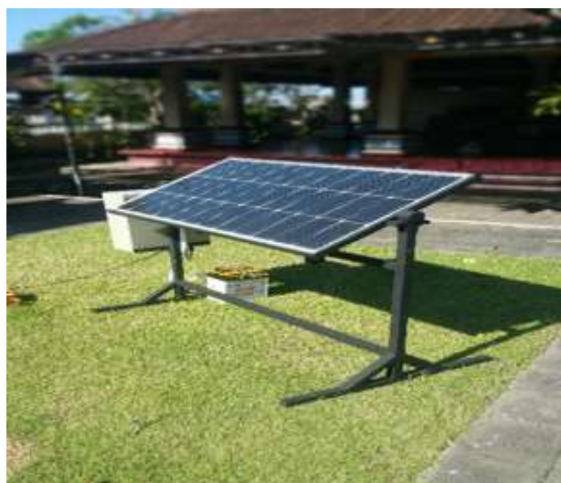
Gambar 3 PLTS dengan solar tracker
