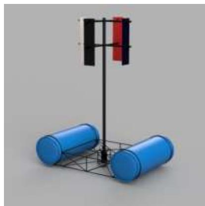
Gambar 3. Desain turbin *type darriues* dengan menggunakan drum sebagai pelampung
