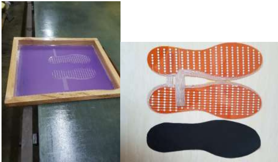
Gambar 4. Pola cetakan sensor (kiri) dan sensor insol (kanan)
