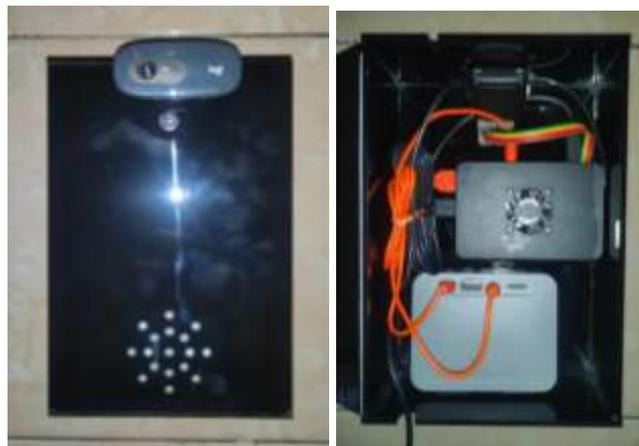
Gambar 5. Realisasi alat pendeteksi masker dan suhu wajah
