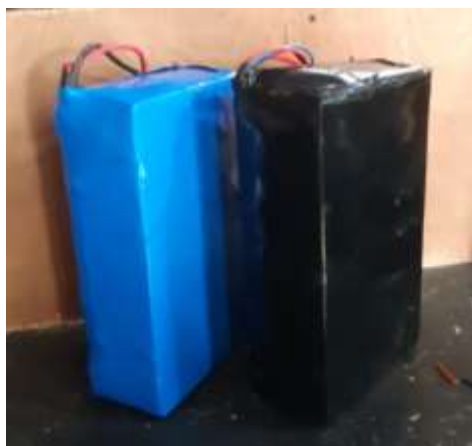
Gambar 5. Baterai lithium NCA dan baterai lithium MNC
