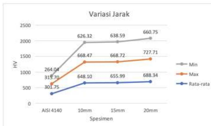
Gambar 3. Variasi Jarak Hasil Uji Vickers
