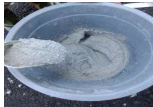
b). Mortar geopolimer dengan metakaolin
