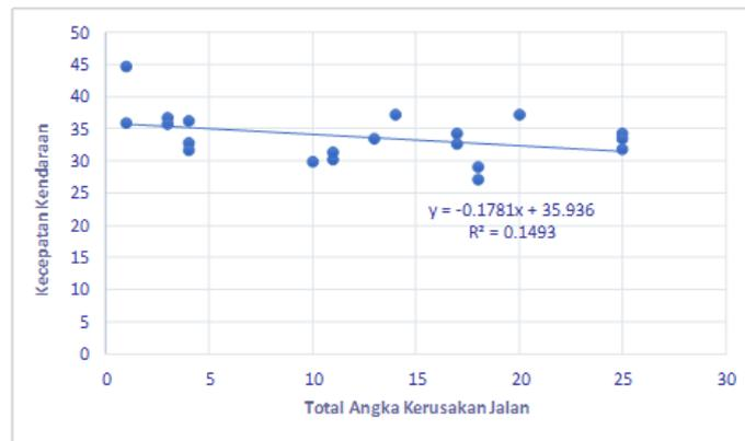
Gambar 3. Hubungan Total Angka Kerusakan Jalan Dengan Kecepatan Kendaraan Untuk Jenis Kendaraan Berat
