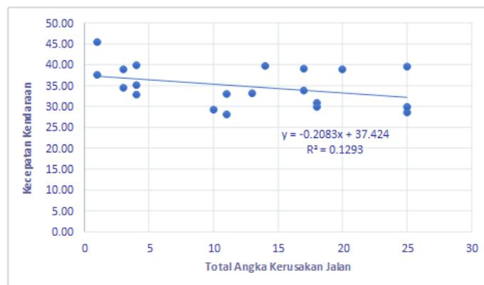
Gambar 4. Hubungan Total Angka Kerusakan Jalan Dengan Kecepatan Rata-Rata Kendaraan
