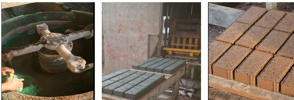
Gambar 1. Proses pencampuran dan pencetakan *paving block* berpori
