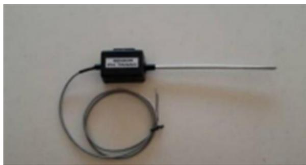
**Gambar 4.** Sensor pH tanah
