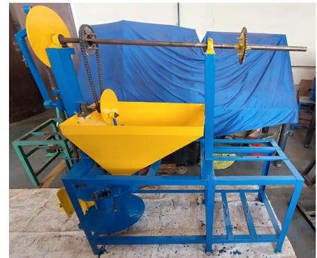
**Gambar 1.** Gambar Rancangan Mesin dan Prototipe Mesin Pres Baglog jamur
