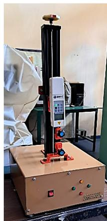
Gambar 6. Hasil Pembuatan Alat Uji Tarik Digital
