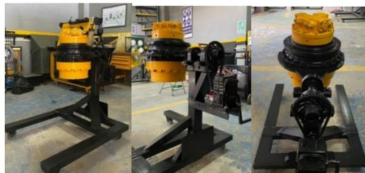
Gambar 5. Hasil Pembuatan *Stand Planetary Final Drive*
