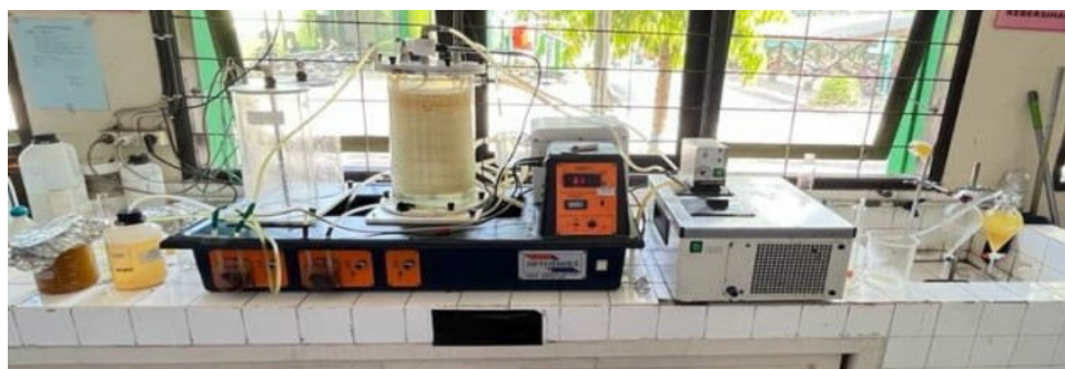
Gambar 1. Produksi Biodiesel dari waste cooking oil (WCO)
