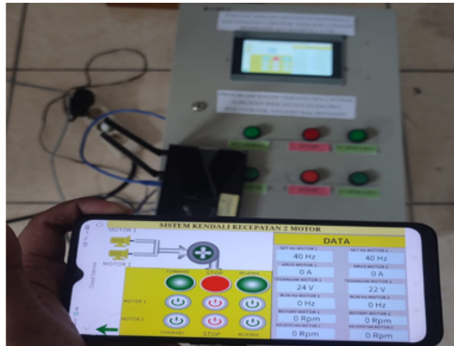
Gambar 3. Pengaturan motor induksi berbasis IoT
