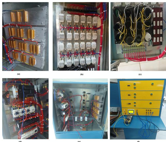
Gambar 6. Hasil rancangan perangkat keras (a) rangkaian beban R, (b) rangkaian beban L, (c) rangkaian beban C, (d) rangkaian kontrol (e) Tampak dalam panel (f) tampak luar panel
