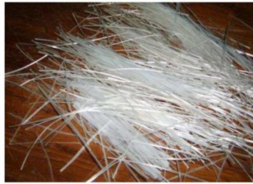
Gambar 3. Bentuk fisik serat *Roving*
