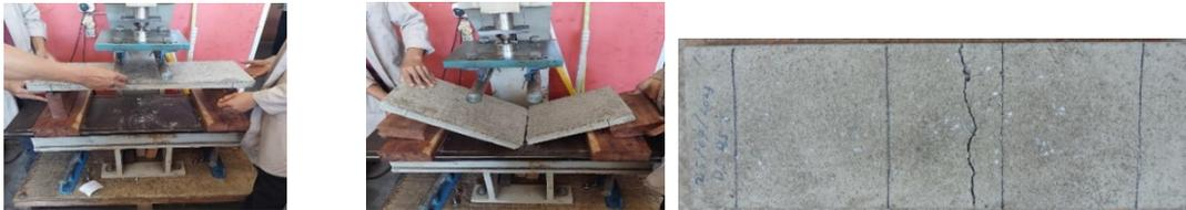
Gambar 9. Benda uji sebelum dan setelah diuji kuat lentur
