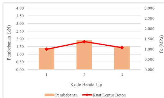
Gambar 4. Grafik pembebanan dan kuat tarik lentur pelat beton tipis dengan biji plastik LDPE sebagai pengganti agregat (tanpa serat limbah daun nanas)
