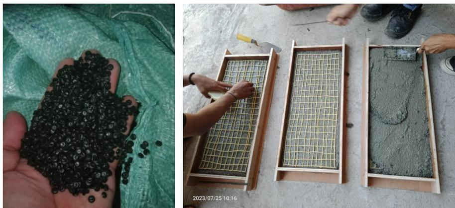
Gambar 1. Material biji plastik LDPE, anyaman serat limbah daun nanas, dan pembuatan benda uji pelat beton tipis
