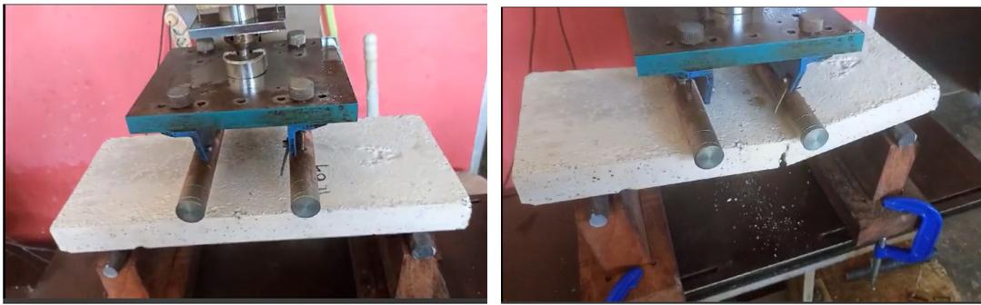
Gambar 3. Pengujian kuat tarik lentur pelat beton menggunakan alat *bending test machine*
