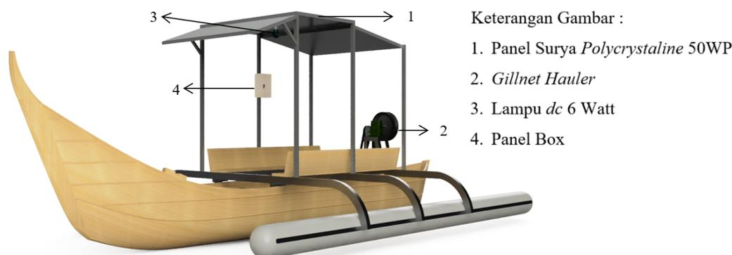
Gambar 3. Skema PLTS pada perahu nelayan
