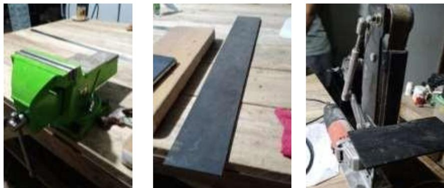
Gambar 1. Ragum, Bahan Pisau Baja stengah Jadi, dan pengasah pisau sederhana yang digunakan pengrajin untuk membuat pisau dapur.
