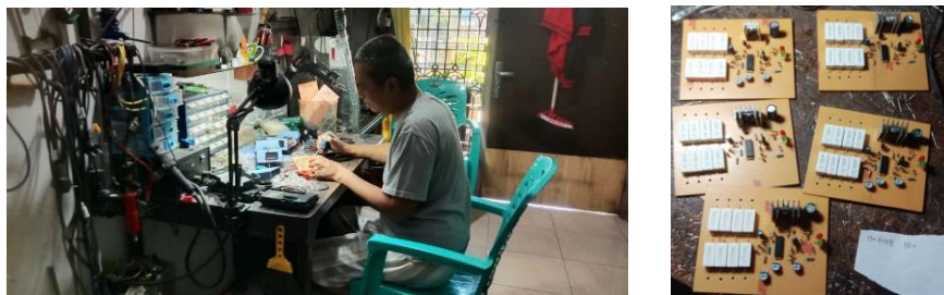
Gambar 5. (a) Mitra (Syahrir) sedang melakukan perakitan komponen pada PCB dan (b) hasil rakitan yang dihasilkan.
