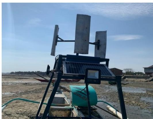
Gambar 2. Pembangkit Listrik *Hybrid Micro* Turbin Angin dan *Solar* PV pada kapal nelayan tradisional
