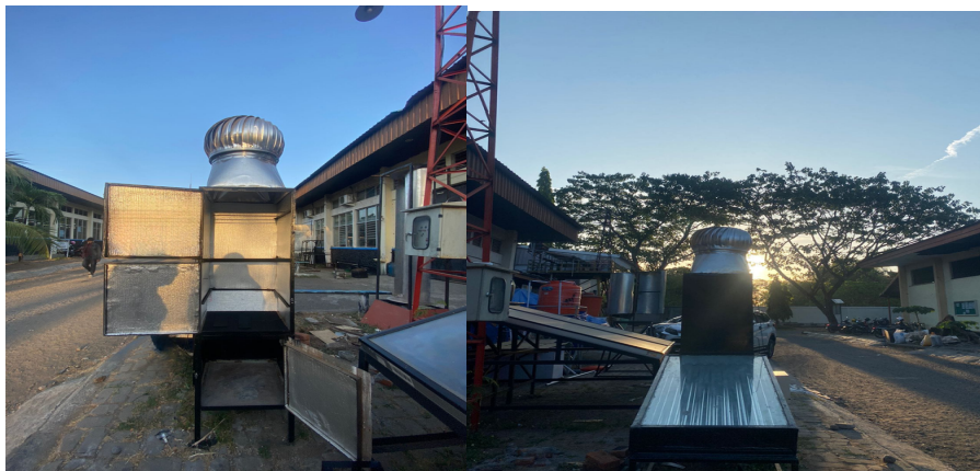
Gambar 2. Alat Pengering Bawang Merah Sistem Hybrid Menggunakan Energi Surya dan Energi
