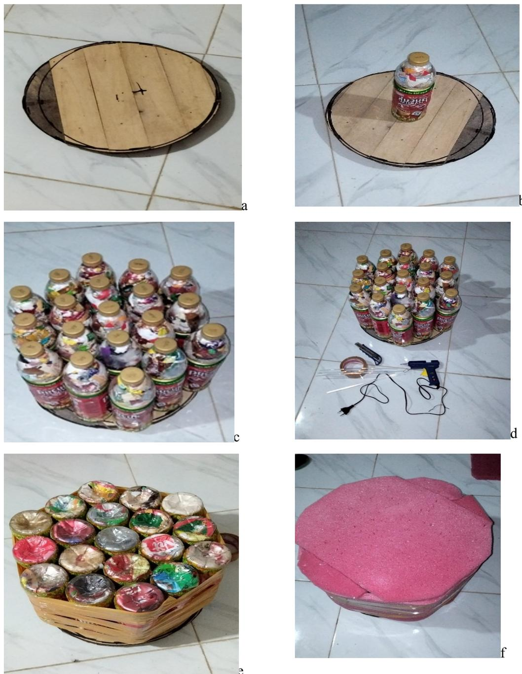
Gambar 2 Tahapan pembuatan ecobrick menjadi tempat duduk
