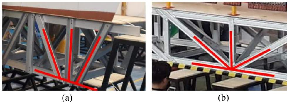
Gambar 3. Model sambungan pada struktur rangka baja ringan.
