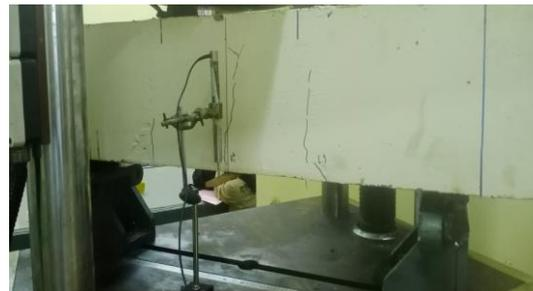
Gambar 8. Pola Retak Balok Sambungan Precast
