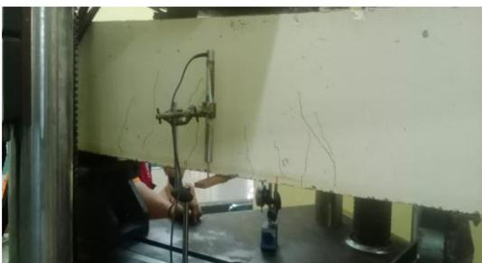
Gambar 7. Pola Retak Balok Konvensional
