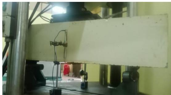
Gambar 5. Pembebanan Benda Uji
