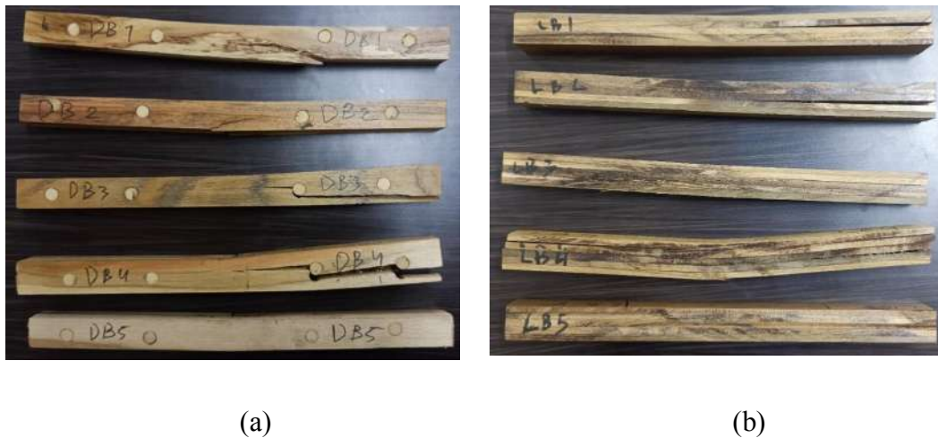
Gambar 5. (a) Kerusakan uji bending sambungan double sawn (b) Kerusakan uji bending sambungan laminasi
