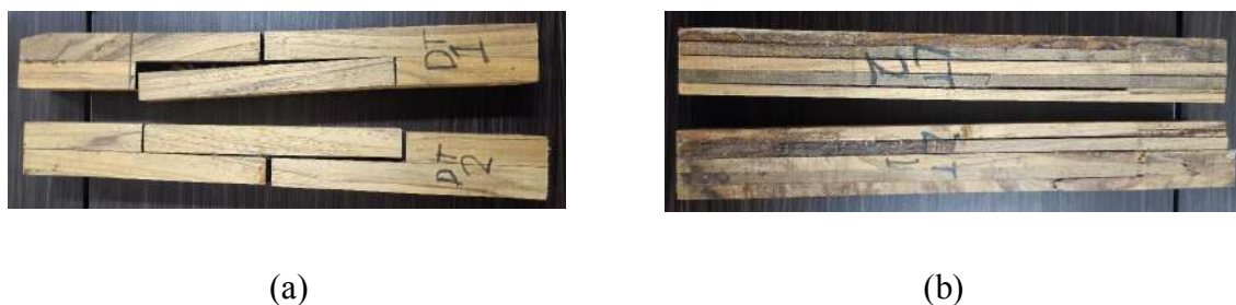
Gambar 6. (a) Kerusakan uji tarik sambungan double sawn (b) Kerusakan uji tarik sambungan laminasi
