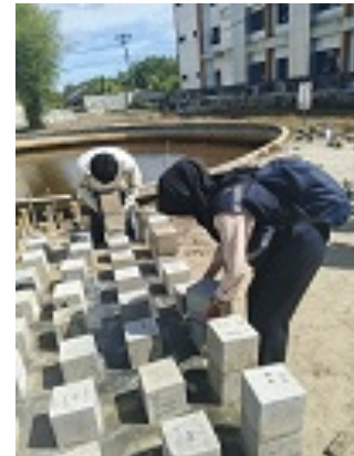
(f) Beton Kubus
