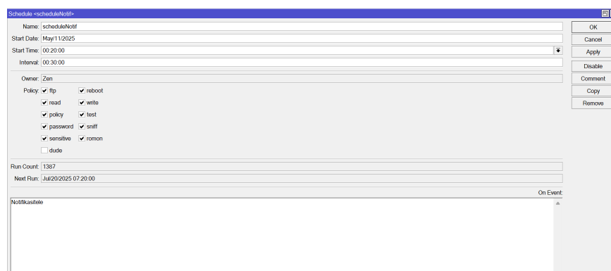
Gambar 5. Konfigurasi Scheduler Pada Mikrotik
