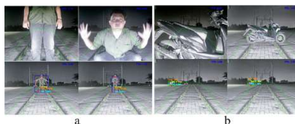
Gambar 3. Pengujian Statis (a) Objek Manusia, (b) Objek Kendaraan
