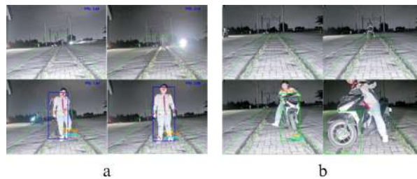
Gambar 5. Pengujian Dinamis (a) Objek Manusia, (b) Objek Kendaraan
