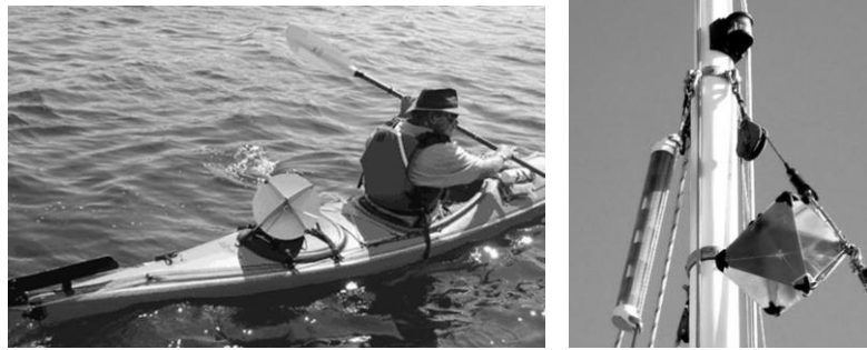
Gambar 1. Penempatan radar reflector pada canoe dan tiang mast kapal
