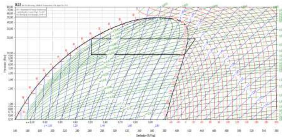
Gambar 5. Plot diagram p-h untuk AC konvensional
