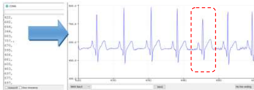
Gambar 9. Pengujian point to point LoRa dan EndNode EKG
