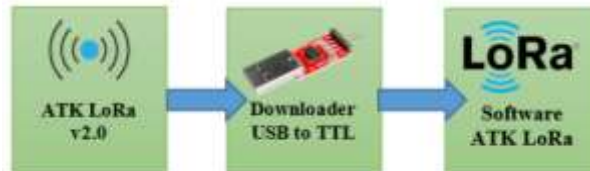
Gambar 3. blok diagram konfigurasi modul LoRa
