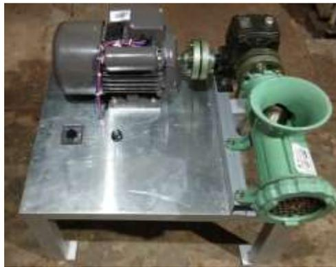
Gambar 3. Mesin penggiling bumbu dapur
