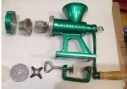
Gambar 1. Alat penggiling manual
