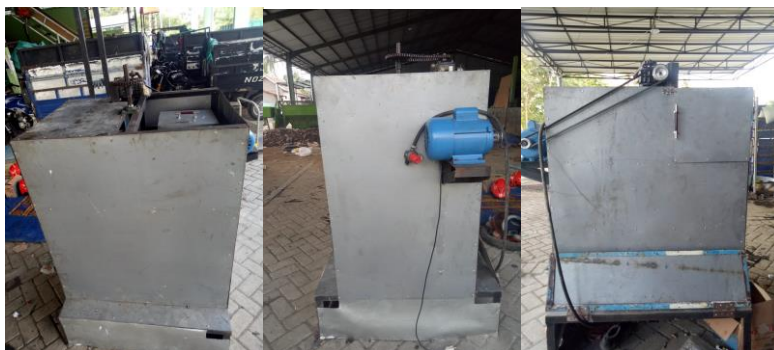
Gambar 3. Hasil perancangan Mesin Melter (peleleh plastik)
