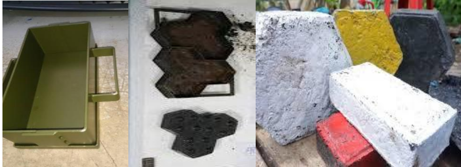
Gambar 6. Bentuk Cetakan dan Hasil Paving dari Plastik
