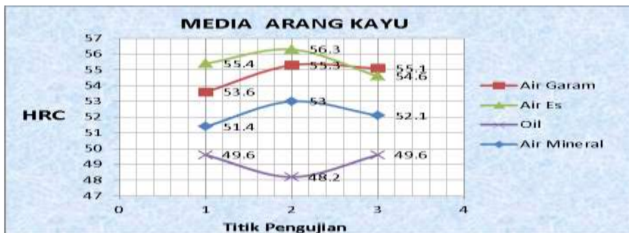
Gambar 6. Pengujian Kekerasan dengan media Arang Kayu
