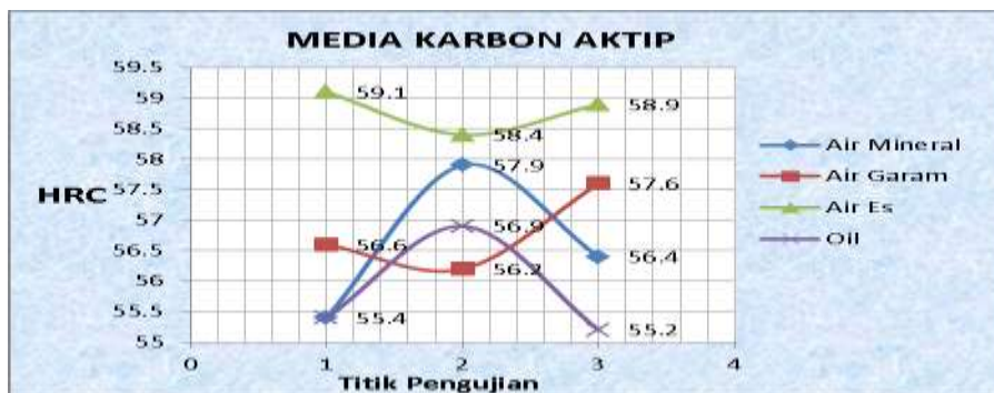
Gambar 7. Pengujian Kekerasan dengan media Karbon Aktif
