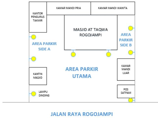
Gambar 2. Kondisi Denah Penerangan dan Masjid At Taqwa Rogojampi
