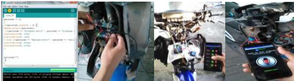
Gambar 7. Proses uploading sketch, instalasi, dan aktivasi sinyal
