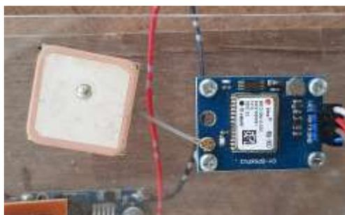
Gambar 7 Hasil Rangkaian Sensor GPS.
