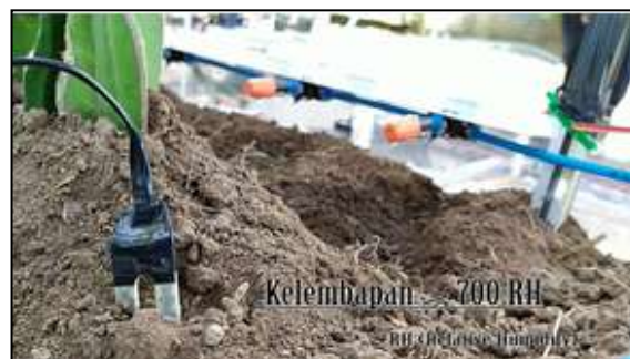
Gambar 2. Sensor Kelembapan Tanah
