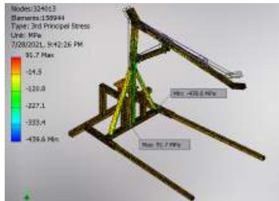
Gambar 7. Posisi Frame Yang Mendapat Tegangan Tekan Maximum dan Minimum
